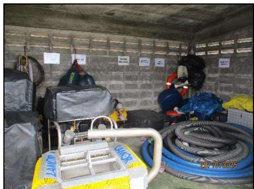
ภาพถ่ายที่ 2.2-3 การจัดเตรียมอุปกรณ์ขจัดคราบน้ำมัน บริเวณท่าเทียบเรือของโครงการ
