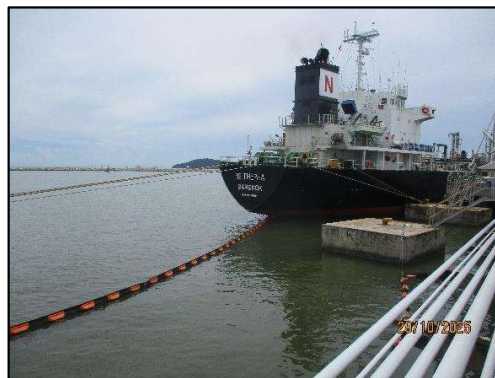
ภาพถ่ายที่ 2.2-2 การติดตั้งอุปกรณ์ป้องกันการรั่วไหล น้ำมัน ขณะมีกิจกรรมการขนถ่าย
